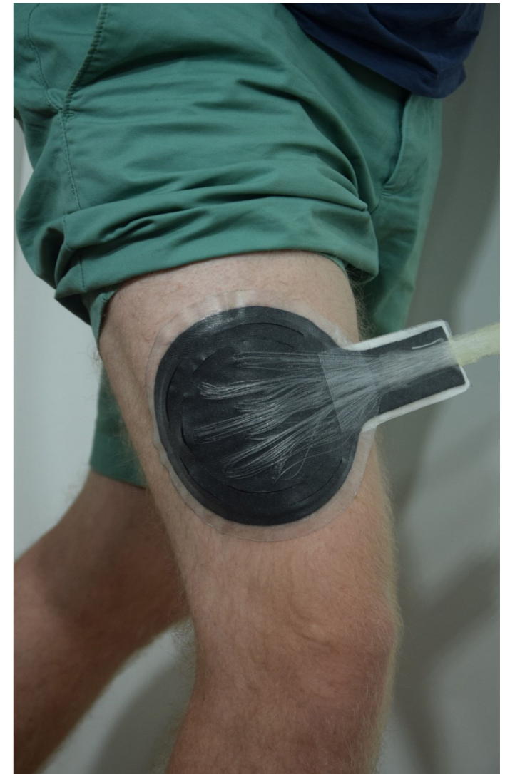
Kontinuierliche Messung der Gewebe-Sauerstoffsättigung unter Verwendung unseres entwickelten tragbaren Sensors.
